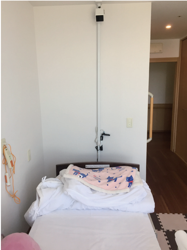
みまもり CUBE 設置図 (ポール設置)
