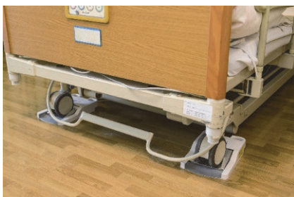
介護ベッドに馴染む車輪止めのようなセンサ
