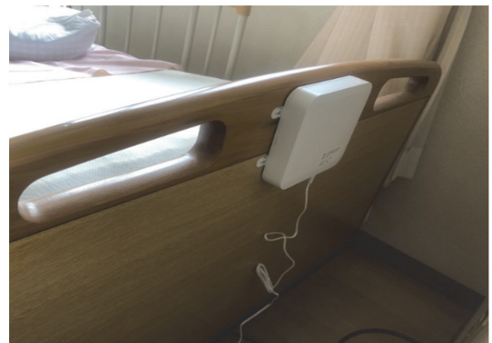
バイタルセンサーの設置状況
